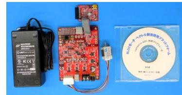
FETドライブ内蔵。5mm角マイコン1個とP+NチャネルFET (TPC8406) 3個でBLDCモータのベクトル制御回路が完成します。
