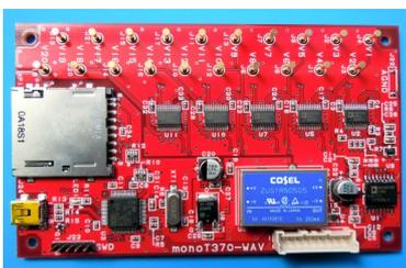
**高電圧・大電流インバータ駆動基板**
